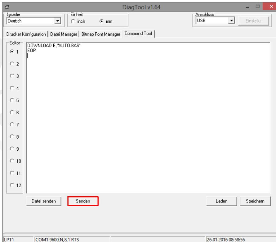
Per „DiagTool / Command Tool“ kann die Konfiguration der „externen Netzwerkparameter“ vorgenommen werden. Die Einstellung erfolgt mit den entsprechenden Befehlszeilen, welche per „Send“- Button an den Drucker übertragen werden.
